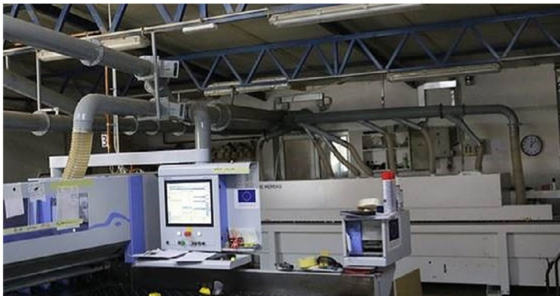
Slika 9. Savremeni efikasni sistem za otprašivanje ugrađen direktno na mašinama [13]
