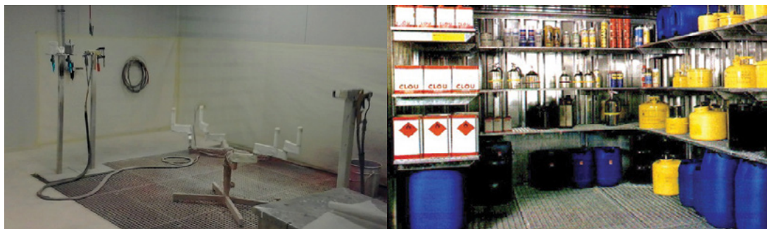
Slika 49. Dobro izolirana, moderna kabina za bojenje/odgovarajuća prostorija za skladištenje hemikalija [77]
