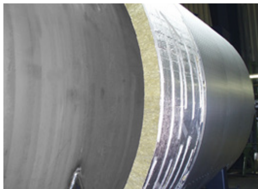
Slika 30. Fiksna izolacija cilindričnog kotla [39]
