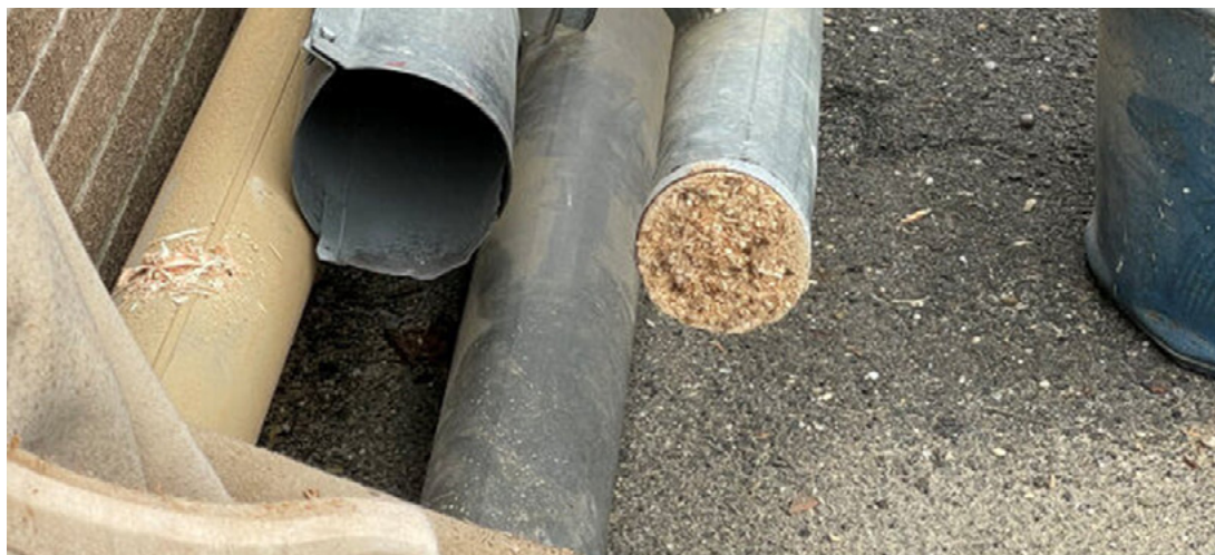
Slika 15. Začepjenost cijevne mreže drvnom piljevinom [13]
